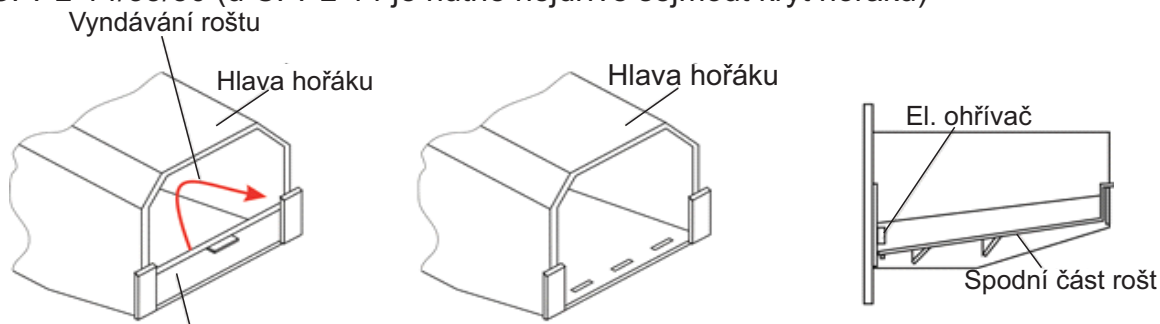
Obr a) Vyndávání roštu spalovací komory za účelem čištění a správná poloha roštu CPPL-14/35/50 (u CPPL-14 je nutné nejdříve sejmout kryt hořáku)
